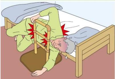
床置き形手すりは、手すりの付属しない木製ベッドに組み合わせて使用されることが多くありますが、ベッドに固定されているわけではありませぬので、どうしても隙間ができてしまいます。このような隙間のリスクを認識して、危険が予想される場合は介護用のベッドを利用するなどの対応が求められます。
